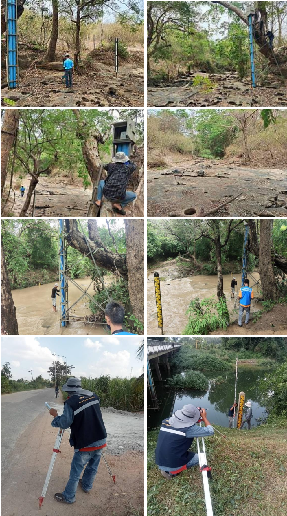
รูปที่ 5.2.2-16 การสำรวจรูปตัดขวางลำน้ำและสำรวจปริมาณน้ำ สถานี Kh.118 บ้านแก่งแต้ ตำบลบ้านค้อ อำเภอดำชะอี จังหวัดมุกดาหาร
